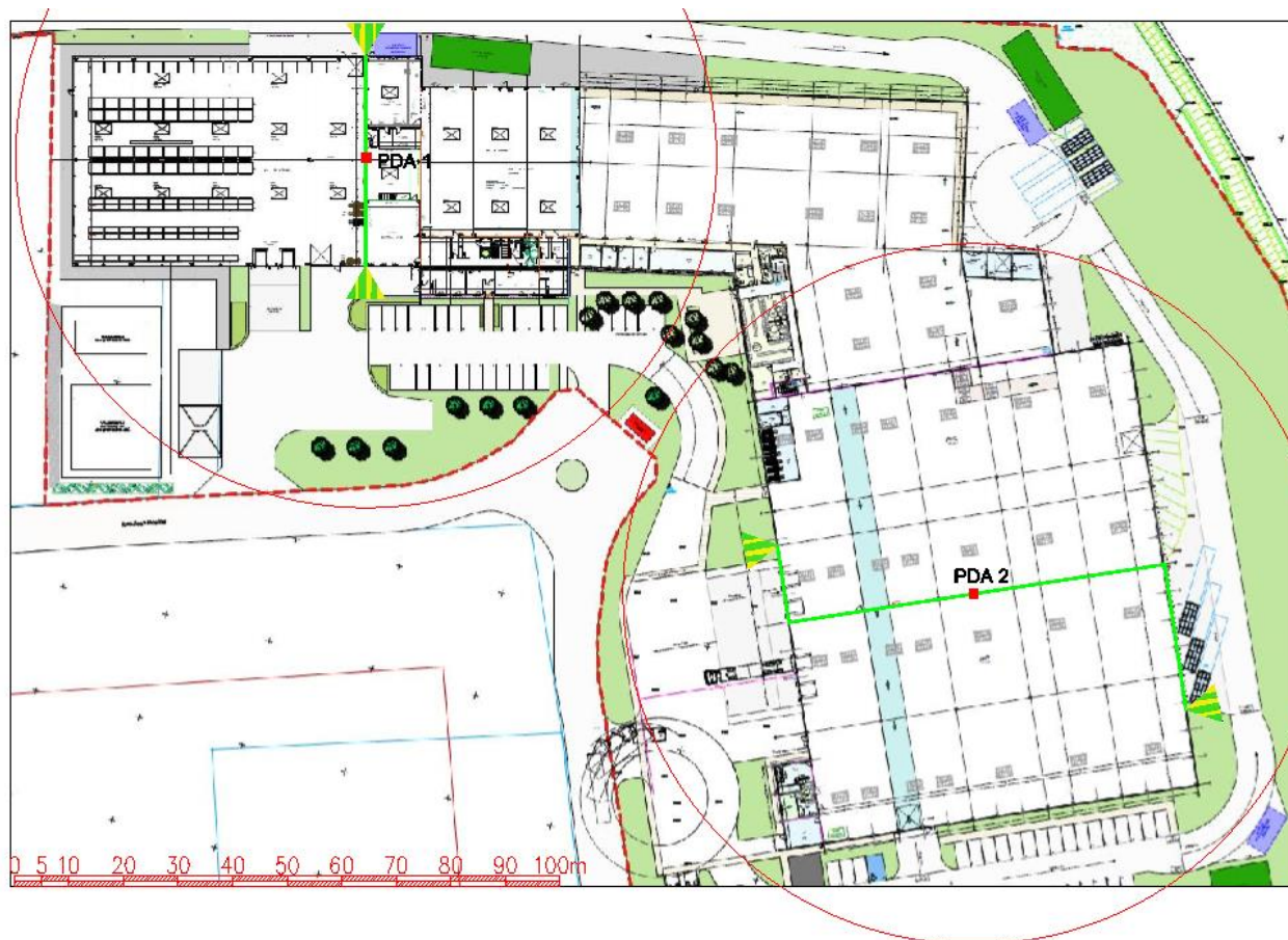
Plan 1: Implantation des paratonnerres, conducteurs de descente et prises de terre
